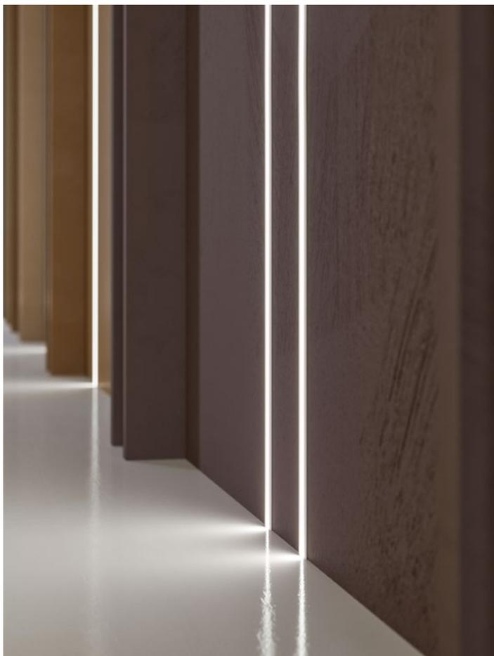
KIPS è un sottilissimo profilo in alluminio ad incasso in cui la strip LED in silicone bianco opale disegna una linea di luce di soli 6mm. Studiata per l'installazione su pannelli in cartongesso a soffitto o parete, la combinazione di moduli lineari e curvi consente originali configurazioni continue da integrare con creatività al progetto degli interni.
