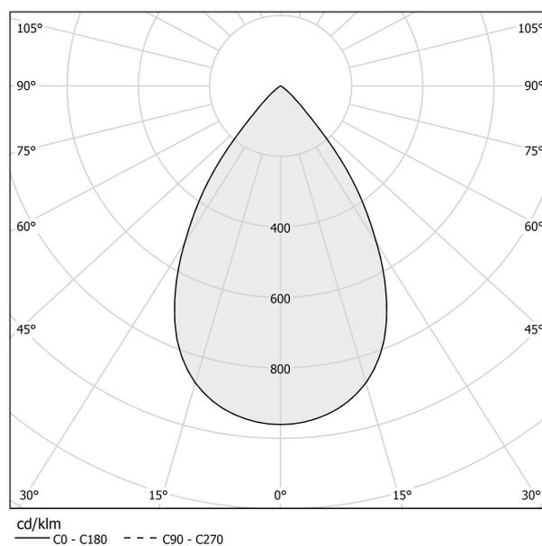
Apparecchio di illuminazione per installazione a soffitto in ambienti interni, con emissione diretta.
