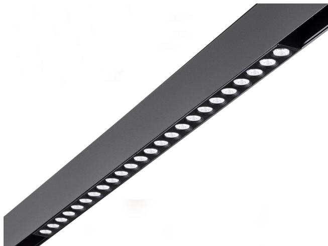
Modulo di luce lineare per binario elettrificato a bassissima tensione 48V per applicazioni soffitto/parete, sospensione e incasso, disponibile in due diverse lunghezze. Corpo in alluminio in colore nero, lenti con fascio 30° in policarbonato e copertura in materiale plastico. Disponibile 2700K e 3000K. Possibilità di dimmerazione tramite protocollo DALI.
