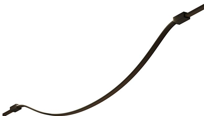
Profilo elettrificato flessibile per installazione a parete e soffitto in ambienti interni. Struttura in policarbonato estruso con finitura in colore nero satinato o legno. Alimentazione a bassa tensione 24V DC. Completo di n.3 box di fissaggio e kit di alimentazione. Sorgenti LED da ordinare separatamente. Lunghezza: 3,05m (120,1").
