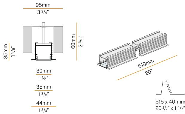
Profilé modulaire d'intérieur pour installation encastrée au plafond ou au mur, avec émission directe.
