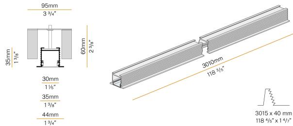
Profilé modulaire d'intérieur pour installation encastrée au plafond ou au mur, avec émission directe.
