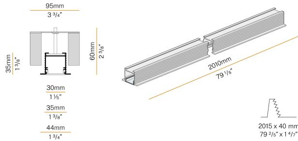
Profilé modulaire d'intérieur pour installation encastrée au plafond ou au mur, avec émission directe.
