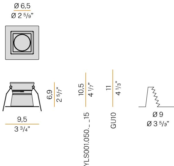
Luminaire d'intérieur pour installation encastrée au plafond, avec émission directe. Structure pour enca斯特ment dans faux-plafonds fixes, en aluminium tourné avec peinture polyacrylique. Cadre de fermeture en aluminium moulé sous pression avec peinture polyacrylique blanc ou noir. Ressort en acier inoxydable pour la fixation de la source lumineuse. Ressorts pour la fixation sur faux-plafonds en acier inoxydable. Dimensions d'encastrement: Ø 90mm (Ø 3,5")
