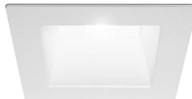
Luminaire d'intérieur pour installation encastrée au plafond, avec émission directe. Structure pour encastrément dans faux-plafonds fixes, en aluminium tourné avec peinture polyacrylique. Cadre de fermeture en aluminium moulé sous pression avec peinture polyacrylique blanche. Ressort en acier inoxydable pour la fixation de la source lumineuse. Ressorts pour fixation sur faux plafond en acier inoxydable. Dimensions d'encastrément: Ø 90mm (Ø 3,5")
