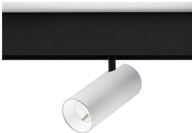
Luminaire pour installation intérieure sur rail électrifié, avec faisceau réglable. Articulation en aluminium moulé sous pression et structure orientable sur deux axes. Cylindre anti-éblouissement et optique à faisceau moyen en matériau thermoplastique. Fourni avec un adaptateur électrique et mécanique pour l'installation sur des rail électrifié à basse tension de 48V.
