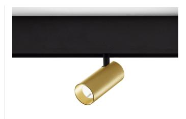
Luminaire pour installation intérieure sur rail électrifié, avec faisceau réglable. Articulation en aluminium moulé sous pression et structure orientable sur deux axes. Cylindre anti-éblouissement et optique à faisceau moyen en matériau thermoplastique. Fourni avec un adaptateur électrique et mécanique pour l'installation sur des rail électrifié à basse tension de 48V.
