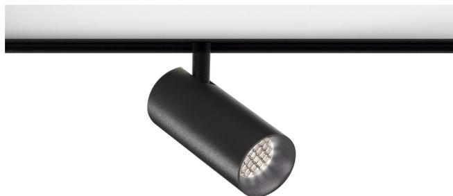
Luminaire pour installation intérieure sur rail électrifié, avec faisceau réglable. Articulation en aluminium moulé sous pression et structure orientable sur deux axes. Cylindre anti-éblouissement et optique à faisceau moyen en matériau thermoplastique. Fourni avec un adaptateur électrique et mécanique pour l'installation sur des rail électrifié à basse tension de 48V.
