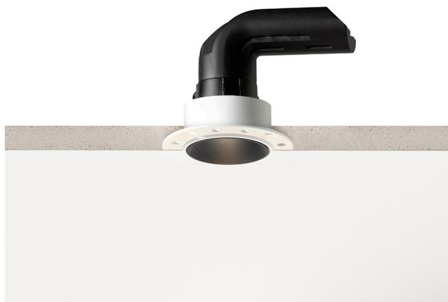
Einbauleuchte für den Innenbereich, mit direkt strahlender Einbaulichthequelle. Struktur aus Aluminiumdruckguss mit schwarzer Pulverbeschichtung, geeignet für den Einbau in feste Decken, auch bei kleinen Abmessungen, min. 70mm (2.8").
