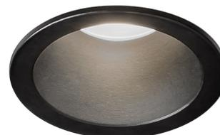
Einbauleuchte für den Innenbereich, mit direkt strahlender Einbaulichthequelle. Struktur für den Einbau in feste Decken, mit Körper aus Aluminiumdruckguss und dünnem sichtbarem Außenrahmen, pulverbeschichtet in weiß oder schwarz. In den Versionen 2700K und 3000K erhältlich. Federn für die Befestigung an Zwischendecken aus rostfreiem Stahl. Mit 0,4 m (15,7") Netzkabel geliefert. Größe der Einbau-Bohrung: Ø 24mm (Ø 1").
