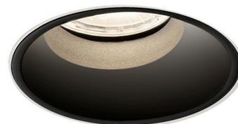
Deckeneinbauleuchte für Innenräume, mit verstellbarem Lichtstrahl. Verdeckte Struktur zum Einbau in feste Abhangdecken, aus Aluminiumdruckguss mit Pulverbeschichtung in Weiß. Auf zwei Achsen verstellbarer Befestigungsring der Lichtquelle, aus thermoplastischem Material. Reflektor aus thermoplastischem Material mit Oberfläche in Weiß oder satiniertem Schwarz. Deckenbefestigungswinkel aus gebleiztem Blech mit Pulverbeschichtung. Größe der Einbau-Bohrung: Ø 74mm (Ø 3")
