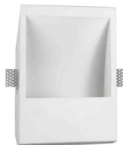
Decken- oder Wandinbauleuchte für Innenräume, mit indirekter Abstrahlung. Verdeckte Gipsstruktur zum Einbau in Mauerwerk oder Gipsplatten. Aluminium-Ableitplatten. Diffusor aus flachem, sandgestrahltem Glas. Befestigungswinkel aus mikroperforiertem Blech. Schalung zum Einbau in Mauerwerk aus verzinktem Blech muss separat bestellt werden. Größe der Einbau-Bohrung: 200x285mm (7,9x11,2")
