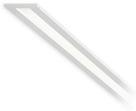
Modulares Decken- oder Wandeinbauprofil für Innenräume, mit direkter Abstrahlung. Struktur zum Einbau in Gipsplatten, aus stranggepresstem Aluminium mit Pulverbeschichtung in Weiß RAL 9003. Lichtmodule und Treiber sind nicht im Lieferumfang enthalten. Befestigungs-, Verbindungs- und Verschlusszubehöre müssen separat bestellt werden. Größe der Einbau-Bohrung: 1005x11mm (39,6x0,4")
