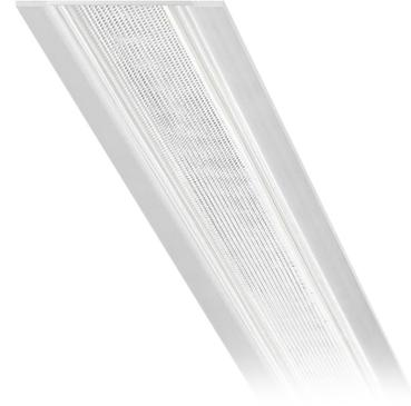
Modulares Decken- oder Wandeinbauprofil für Innenräume, mit direkter Abstrahlung. Struktur zum Einbau in Gipsplatten, aus stranggepresstem Aluminium mit Pulverbeschichtung in Weiß RAL 9003. Diffusor aus mikroprismatischem, extrudiertem Polycarbonat. Lichtmodule und Treiber sind nicht im Lieferumfang enthalten. Befestigungs-, Verbindungs- und Verschlusszubehöre müssen separat bestellt werden. Größe der Einbau-Bohrung: 1015x40mm (40x1,6")
