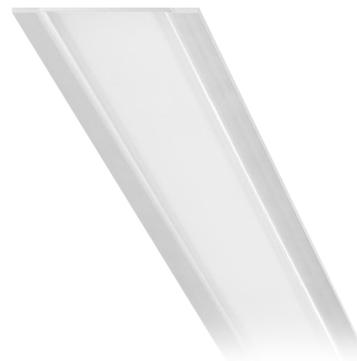
Modulares Decken- oder Wandeinbauprofil für Innenräume, mit direkter Abstrahlung. Struktur zum Einbau in Gipsplatten, aus stranggepresstem Aluminium mit Pulverbeschichtung in Weiß RAL 9003. Diffusor aus extrudiertem Polycarbonat mit Opal-Finish. Lichtmodule und Treiber sind nicht im Lieferumfang enthalten. Befestigungs-, Verbindungs- und Verschlusszubehöre müssen separat bestellt werden. Größe der Einbau-Bohrung: 1015x40mm (40x1,6")
