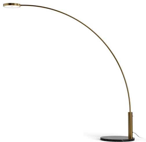
Stehleuchte für den Innenbereich mit direkter oder indirekter Abstrahlung. Sockel aus schwarzem Marquina-Marmor. Stiel aus kalandriertem Stahlrohr, mit Polyacryllackierung. Drehbarer Kopf aus Aluminiumdruckguss, mit Polyacryl-Lackierung in Champagner, Satinschwarz und Bronze Ausführungen. Diffusor mit UV-Siebdruck aus opalem Polycarbonat. Montage mit Magnetkupplung.
