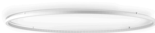
Decken- oder Wandleuchte für den Innenbereich, mit direkter Abstrahlung. Struktur aus gebogenem, stranggepresstem Aluminium mit Polyacrylfarbe in Weiß, Schwarz oder satiniertem Messing. Diffusor aus extrudiertem Polycarbonat mit Opal-Finish. Abstandshalter für die Deckenbefestigung aus gedrehtem Messing mit Polyacrylfarbe.
