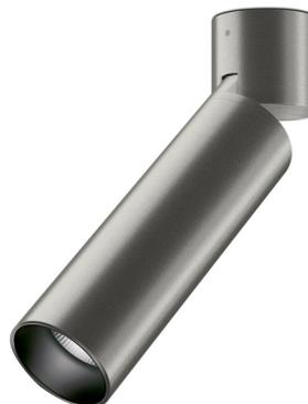
Decken- oder Wandleuchte für den Innenbereich, mit verstellbarem Lichtstrahl. Wandmontageplatte zur Decken-/Wandbefestigung aus Aluminiumdruckguss mit Polyacrylfarbe. Fach für den Stromanschluss aus Aluminiumdruckguss mit Polyacrylfarbe. Gelenk aus Aluminiumdruckguss mit Polyacrylfarbe. Um zwei Achsen verstellbare Struktur aus Aluminiumdruckguss mit Polyacrylfarbe in Weiß, Schwarz, Bronze, satiniertem Messing oder Titan. Reflektor aus thermoplastischem Material mit verchromter Oberfläche.
