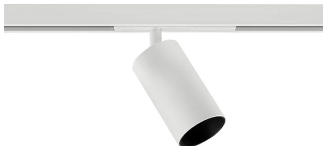
Leuchte für Stromschiene für Innenräume, mit verstellbarem Lichtstrahl. Gelenk aus Aluminiumdruckguss mit Pulverbeschichtung. Zwei-Achsen-Schwenkstruktur aus Aluminiumdruckguss mit weißer oder schwarzer Pulverbeschichtung. Reflektor aus thermoplastischem Material mit verchromter Oberfläche. Schirm aus texturiertes Glas. Blendschutz-Zylinder aus schwarzem thermoplastischem Material. Mit elektrischem und mechanischem Adapter für elektrifizierte 48-V-Niederspannungsgleise ausgestattet.
