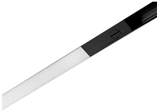
Lineares Lichtmodul für Stromschiene für Innenräume mit direkter Abstrahlung. Struktur aus eloxiertem, stranggepresstem Aluminium. Diffusoren aus extrudiertem Polycarbonat mit Opal-Finish. Endkappen aus schwarzem thermoplastischem Material mit Befestigungsmechanismus zur Montage auf 48V-Niederspannungs-Stromschienen.
