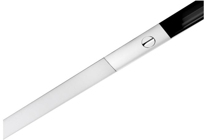
Lineares Lichtmodul für Stromschiene für Innenräume mit direkter Abstrahlung. Struktur aus eloxiertem, stranggepresstem Aluminium. Diffusoren aus extrudiertem Polycarbonat mit Opal-Finish. Endkappen aus schwarzem thermoplastischem Material mit Befestigungsmechanismus zur Montage auf 48V-Niederspannungs-Stromschienen.
