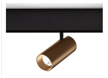
Leuchte für die Innenmontage an einer Stromschiene, mit verstellbarem Lichtkegel.  ${\it Gelenk\ aus\ Aluminium druckguss\ und\ zweiach sig\ schwenkbare\ Struktur.}$  $Blendfreier\ Zylinder\ und\ mittelstrahlende\ Linse\ aus\ thermoplastischem\ Material.$ Geliefert komplett mit elektrischem und mechanischem Adapter für die Installation auf elektrischen Niederspannungsschienen mit 48 V.
