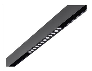
Lineares Lichtmodul für 48V-Kleinspannungs-Stromschienen für Decken-/Wand-, Abhänge- und Einbauanwendungen, erhältlich in zwei verschiedenen Längen. Schwarzer Aluminiumkörper, Polycarbonatlinsen mit  $30^\circ$  Abstrahlwinkel und Kunststoffabdeckung.
