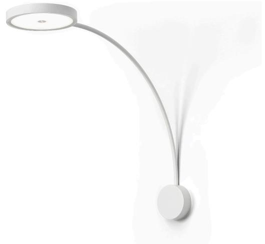
Leuchte für Wandmontage in Innenräumen, mit direkter oder indirekter Abstrahlung. Deckenbaldachin mit Deckenhalterung aus gebeiztem Stahlblech und Gehäuse mit Magnetverschluss aus tiefgezogenem Stahlblech. Arm aus kalandriertem Stahlrohr, mit Polyacryllackierung. Drehkopf aus Aluminiumdruckguss, mit Polyacryllackierung in den Farben Champagner, Schwarz satiniert, Bronze und strukturiertem Softweiß. Diffusor mit UV-Siebdruck aus opalem Polycarbonat. Montage mit Magnetkupplung.
