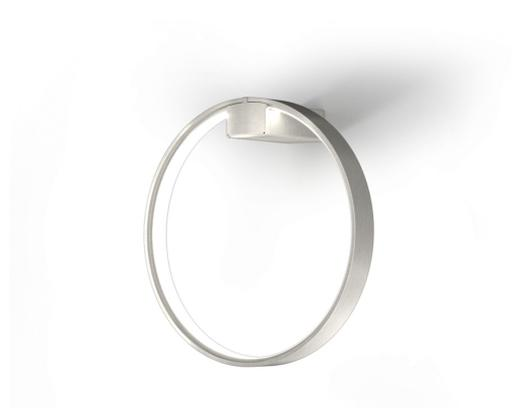
Innenraum-Wandleuchten, mit direkter und indirekter Abstrahlung. Wandbefestigungswinkel aus gebeiztem Blech mit Polyacrylfarbe. Wandmontageplatte aus gebeiztem Blech mit Polyacrylfarbe. Struktur aus gebogenem stranggepresstem Aluminium mit Polyacrylfarbe in Weiß, Schwarz, Bronze, satiniertem Messing oder Titan erhältlich. Diffusor aus extrudiertem Polycarbonat mit Opal-Finish.
