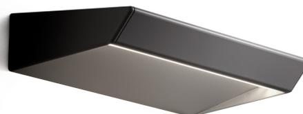
Innenraum-Wandleuchte, mit direkter und indirekter Abstrahlung. Wandbefestigungswinkel aus gebeiztem Blech mit Polyacrylfarbe. Struktur aus stranggepresstem Aluminium mit Polyacrylfarbe in Weiß, Schwarz, Bronze, satiniertem Messing oder Titan erhältlich. Diffusoren aus extrudiertem Acrylmaterial mit Opal-Finish. Endkappen aus Aluminiumdruckguss mit Polyacrylfarbe.
